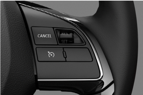
مثبت السرعة تتم المحافظة على سرعة السيارة أتوماتيكياً دون الحاجة إلى إبقاء قدمك على دواسة الوقود، بما يجعل القيادة لمسافات طويلة أكثر راحة واسترخاء. لوقف عمل نظام مثبت السرعة، عليك الضغط على دواسة الفرامل. Cruise control Vehicle speed is automatically maintained without keeping your foot on the accelerator pedal, allowing more relaxed driving on extended journeys. Pressing the brake pedal disengages the system.
