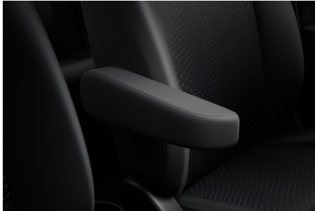
مسند ذراع قابل للتعديل لمقعد السائق يضم مقعد السائق مسند ذراع قابل للتعديل لتعزيز الشعور بالراحة أثناء القيادة، وتقليل الإحساس بالتعب والإجهاد عند القيادة لمسافات طويلة. يمكن تعديل المسند أفقياً للحصول على وضعية مثالية. Driver's seat adjustable armrest The driver's seat includes an adjustable armrest to enhance driving comfort and reduce strain on long drives. It can be adjusted horizontally for the ideal position.
