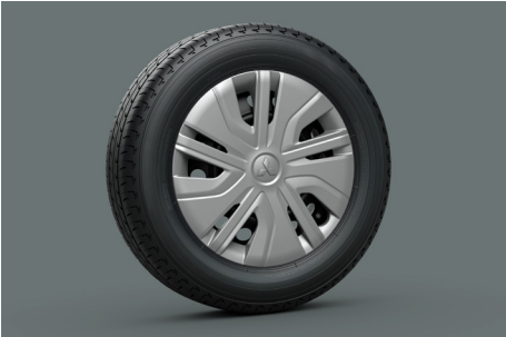
إطارات 175/65R14 + عجلات فولاذ قياس 14 بوحة مع غطاء 175/65R14 tyres + 14-inch steel wheels with cover
