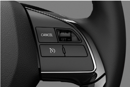
مثبت السرعة تتم المحافظة على سرعة السيارة أتوماتيكياً دون الحاجة إلى إبقاء قدمك على دواسة الوقود، مما يجعل القيادة لمسافات طويلة أكثر راحة واسترخاء. لوقف عمل نظام مثبت السرعة، عليك الضغط على دواسة الفرامل.
